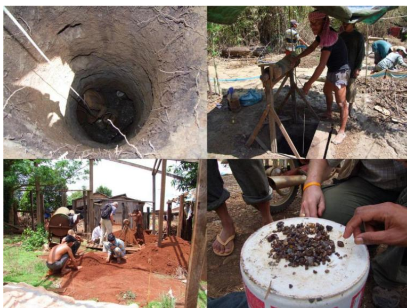
รูปที่ 5 ขั้นตอนการทำเหมืองเพทายในจังหวัดรัตนคีรี ประเทศกัมพูชา
