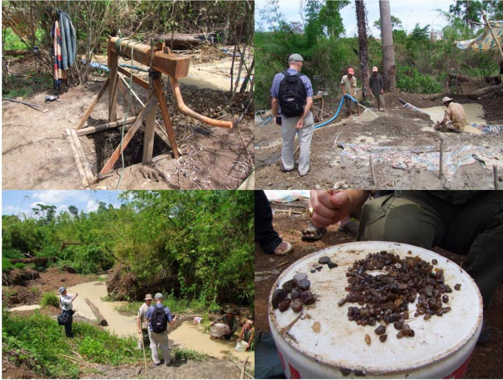
รูปที่ 11 การทำเหมืองแบบเปือก มีการร่อนแร่โดยใช้น้ำช่วยในการคัดแยกเพทायออกจากตะกอนอื่นๆ
