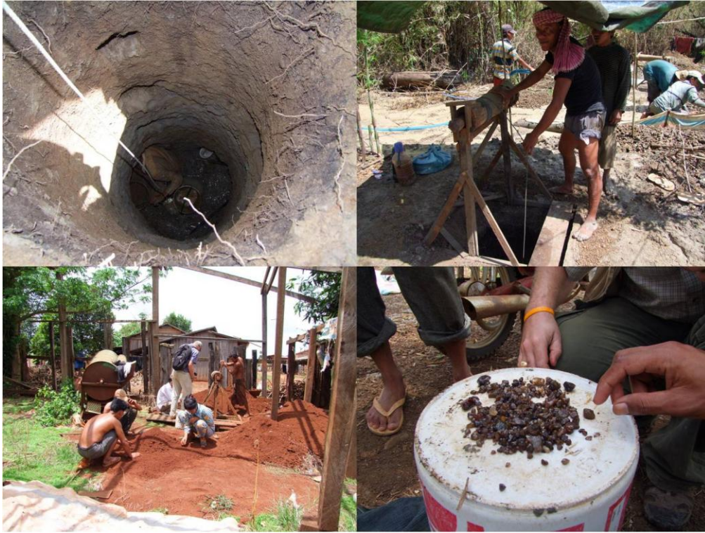
รูปที่ 13 ขั้นตอนการทำเหมืองเพทายในจังหวัดรัตนคีรี ประเทศกัมพูชา
