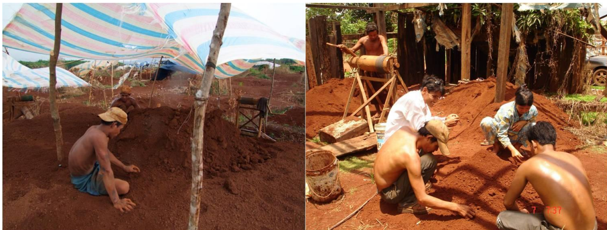
รูปที่ 12 การทำเหมืองแบบแห้ง โดยการแยกเพทायออกจากดินซึ่งเกิดจากการผุของหินให้พลอย
