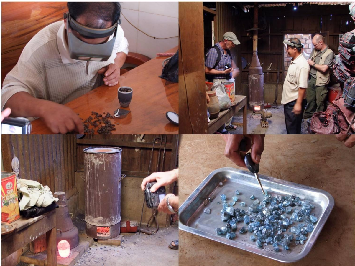
รูปที่ 16 การเผาเพทายเพื่อปรับปรุงคุณภาพสีด้วยเตาถ่าน
