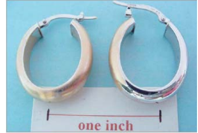
รูป 1 ต่างหูทำจาก white gold ก่อน (ขวา) และหลังชุบโรเดียมแล้ว เปิดผิวเคลือบบางส่วน (ซ้าย) 1
